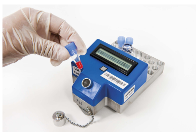
Avlägsna reagenskoppen och gör en visuell kontroll av klott
